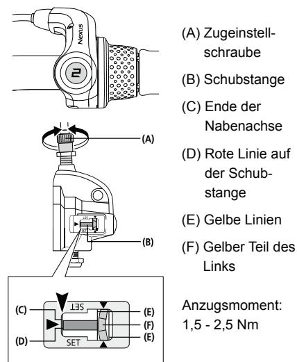
Schalten Sie den REVOSHIFT Hebel auf 2. Drehen Sie dann die Zugeinstellschraube (A), um die rote Linie (D) auf der Schubstange am Ende (C) der Nabennachse auszurichten.
