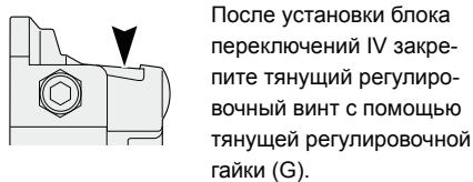
После установки блока переключений IV закрепите тяущий регулировочный винт с помощью тяущей регулировочной гайки (G).
